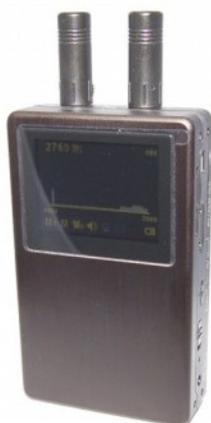
**Обнаружитель скрытых видеокамер + сканер частот «Interceptor-300 DVR»** - современное компактное устройство, основным назначением которого является поиск скрытых видеокамер по излучаемому ими радиосигналу.
